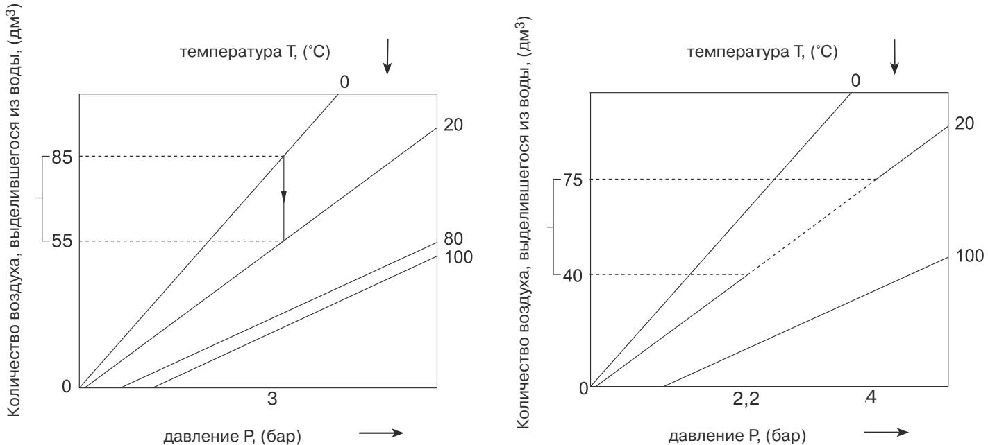
При повышении температуры воды при постоянном давлении в системе или при понижении давления при постоянной температуре происходит высвобождение растворенного в воде воздуха. Данные диаграммы, иллюстрирующие закон Генри, позволяют определить количество выделившегося из воды воздуха (ранее растворенного).
