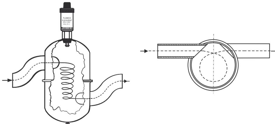
Работа сепараторов воздуха Flexair основывается на центробежном принципе. Благодаря тангенциально расположенным патрубкам сепаратора вода в нем закручивается. Более тяжелая фракция (вода) прижимается силами инерции к стенкам сепаратора, а более легкая (воздух) собирается внутри.
