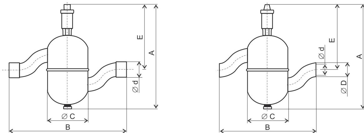
**Таблица № 38. Основные характеристики сепараторов воздуха Flexair, присоединение сварка и резьба**
