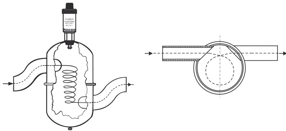
Работа сепараторов воздуха Flexair основывается на центробежном принципе. Благодаря тангенциальному расположенным патрубкам сепаратора вода в нем закручивается. Более тяжелая фракция (вода) прижимается силами инерции к стенкам сепаратора, а более легкая (воздух) собирается внутри.
