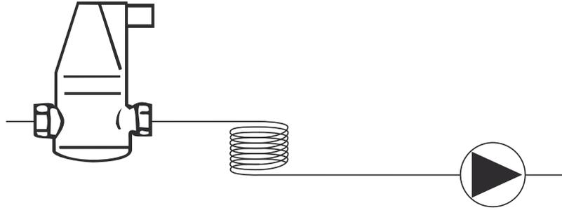
При статической высоте системы выше 30 м, рекомендуется установка сепараторов воздуха Flamsovent на каждом этаже выше этого уровня.
