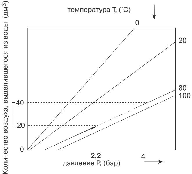
При повышении температуры воды при постоянном давлении в системе или при понижении давления при постоянной температуре происходит высвобождение растворенного в воде воздуха. Данные диаграммы, иллюстрирующие закон Генри, позволяют определить количество выделившегося из воды воздуха (ранее растворенного).
