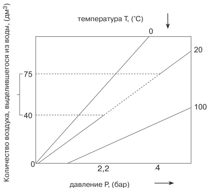
Наибольшее количество воздуха (самые большие пузырьки) выделяется в местах с малым давлением (верхняя часть системы), что является наилучшим местом для установки сепаратора воздуха Flamcovent. Чтобы решить вопрос об установке сепаратора Flamcovent до или после радиатора охлаждения и циркуляционного насоса, воспользуемся следующими данными:
