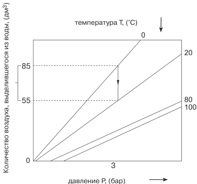
При повышении температуры воды при постоянном давлении в системе или при понижении давления при постоянной температуре происходит высвобождение растворенного в воде воздуха. Данные диаграммы, иллюстрирующие закон Генри, позволяют определить количество выделившегося из воды воздуха (ранее растворенного).
