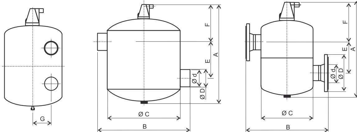
**Таблица № 39. Основные характеристики сепараторов воздуха Flexair, присоединение сварка и фланцы**
