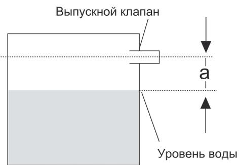
Сравним коническую и цилиндрическую камеры воздухоотводчиков, у которых одинаковая высота и площадь основания. При повышении уровня воды в обеих камерах повышение давления в конической будет увеличиваться больше, чем в цилиндрической вследствие ее меньшего объема. Следовательно, баланс давления в конической камере будет достигнут при уровне воды ниже, чем в цилиндрической. В этом
