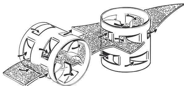
**Таблица № 33. Типоразмеры PALL-кольец, используемых в сепараторах воздуха Flamcovent**
