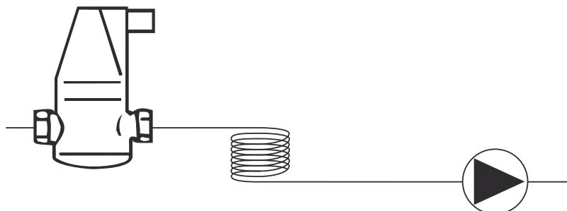
При статической высоте системы выше 30 м, рекомендуется установка сепараторов воздуха Flamcovent на каждом этаже выше этого уровня.
