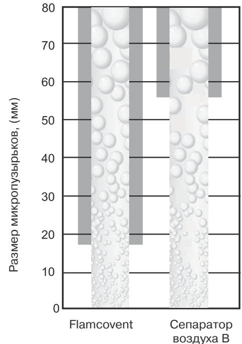
Диаграмма графически представляет результаты тестов. Сравнение произведено с аналогичным сепаратором воздуха, доступным на рынке, который также принимал участие в тестировании. Диаграмма показывает, что сепаратор воздуха Flamcovent позволяет отделить пузырьки воздуха диаметром втрое меньше, чем аналогичный сепаратор. Следовательно, сепаратор воздуха Flamcovent очистит систему от воздуха не только быстрее, но и полнее.
