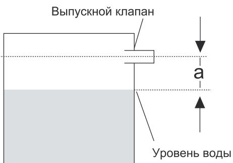
Сравним коническую и цилиндрическую камеры воздухоотводчиков, у которых одинаковая высота и площадь основания. При повышении уровня воды в обеих камерах повышение давления в конической будет увеличиваться больше, чем в цилиндрической вследствие ее меньшего объема. Следовательно, баланс давления в конической камере будет достигнут при уровне воды ниже, чем в цилиндрической. В этом
