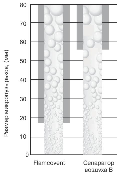
Диаграмма графически представляет результаты тестов. Сравнение произведено с аналогичным сепаратором воздуха, доступным на рынке, который также принимал участие в тестировании. Диаграмма показывает, что сепаратор воздуха Flamcovent позволяет отделить пузырьки воздуха диаметром втрое меньше, чем аналогичный сепаратор. Следовательно, сепаратор воздуха Flamcovent очистит систему от воздуха не только быстрее, но и полнее.
