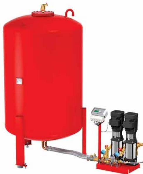
При охлаждении теплоносителя в системе его объем уменьшается и давление падает. Если давление падает ниже установленного уровня, то блок управления включает насос. Насос работает до тех пор, пока давление в системе не поднимется до установленного уровня.
